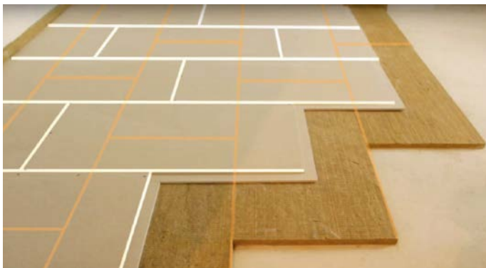
Рис. 10. Разбежка швов сухой стяжки и звукоизоляционных плит
