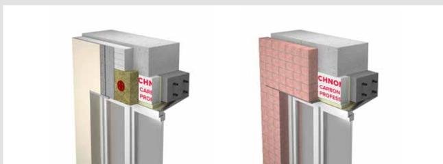
При устройстве перемычки из сборного железобетона вместо одной из балок вставляют термовкладыши из XPS ТЕХНОНИКОЛЬ CARBON.
