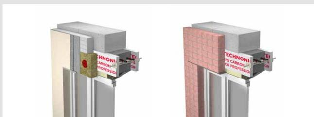
Использование несъемной опалубки из XPS ТЕХНОНИКОЛЬ CARBON и модульных стяжек ТЕХНОНИКОЛЬ в качестве связей для устройства перемычек.
