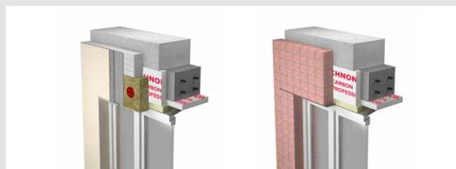
При устройстве монолитной перемычки с применением съемной опалубки предлагается устройство теплового контура из XPS ТЕХНОНИКОЛЬ CARBON.
