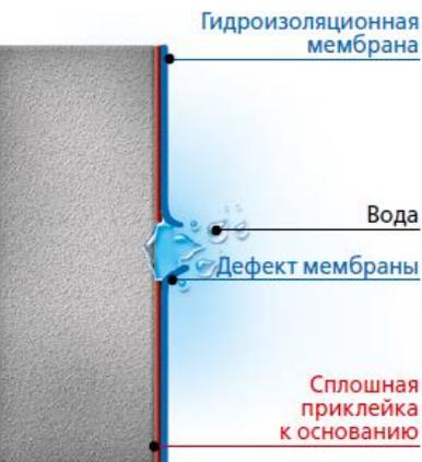
(Б) - метод сплошного наплавления
