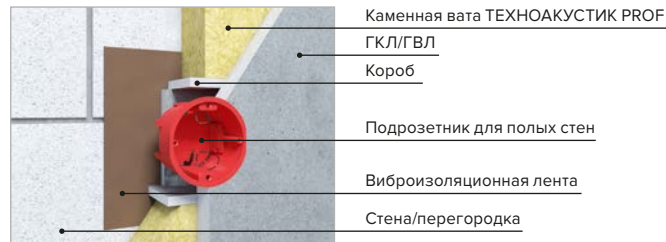
Рис. 18 в. Вариант монтажа электропроводки в несущей стене и подрозетника с монтажом в специальный короб
