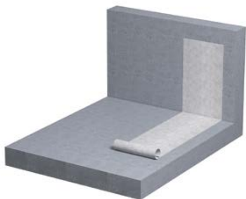
1. Монтаж подстилающего слоя геотекстиля.
