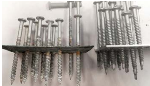
Саморезы другого изготовителя после нахождения в испытательной камере в течение 1000 часов
