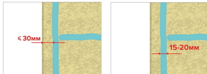
Рис. 8. Правила нанесения клея-пены
