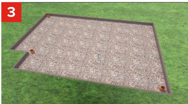
**3** Произвести послойную засыпку котлована щебнем и песком, с обязательным трамбованием и смачиванием каждого слоя на предварительно уложенный слой геотекстиля.
