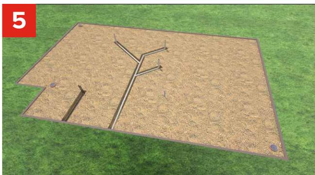
**5** Выполнить укладку инженерных коммуникаций и закладных пластиковых труб канализации, которые прокладываются через толщину песчаной подушки. Произвести отсыпку траншей песком.
