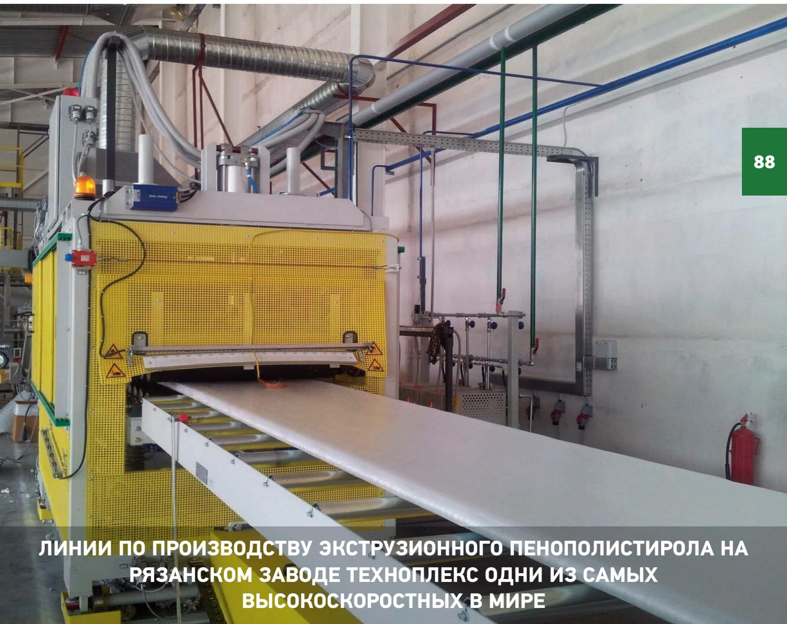
**ЛИНИИ ПО ПРОИЗВОДСТВУ ЭКСТРУЗИОННОГО ПЕНОПОЛИСТИРОЛА НА РЯЗАНСКОМ ЗАВОДЕ ТЕХНОПЛЕКС ОДНИ ИЗ САМЫХ ВЫСОКОСКОРОСТНЫХ В МИРЕ**
