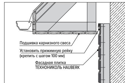
Рис. 9.1. Монтаж верхнего ряда под карнизным свесом
