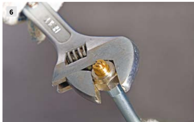
6 На конце удлинительного элемента пистолета установлена форсунка. Она служит для лучшего распыления контактного клея. Для нанесения пены снимайте форсунку.
