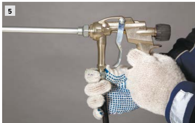
5 Откройте вентиль на пистолете. Теперь система готова к работе. Для распыления клея нажимайте на курок на пистолете.
