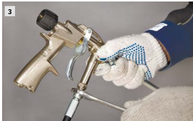
3 Прикрутите другой фланец шланга к распылительному пистолету.
