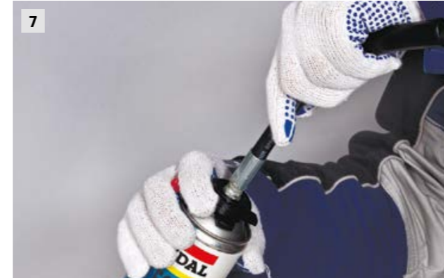
7 Используйте aerosольный баллончик очистителя пены. Прижмите фланец шланга к носику баллончика, не оставляя зазора, чтобы чистящее средство поступало в шланг под давлением.
